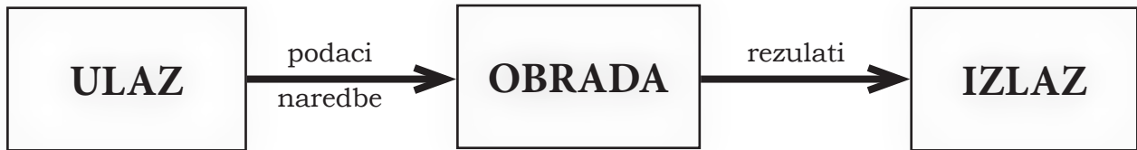
Slika 2. Osnovna funkcionalna shema računara
